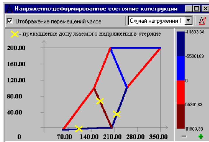
Рис.3.9. Напряжено-деформованний стан ферменної конструкції
