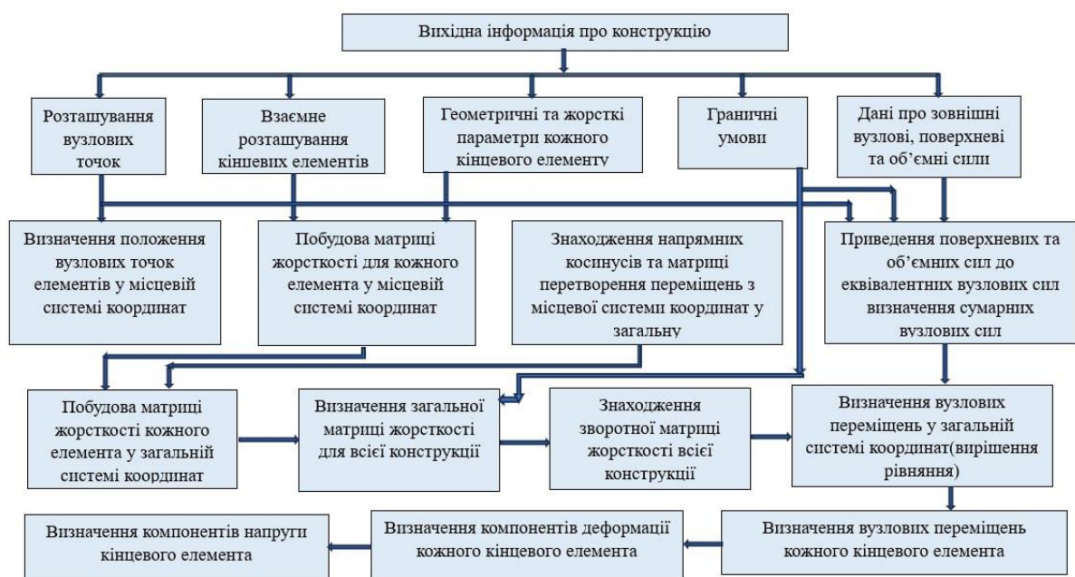
Рис. 1.3. Блок-схема розрахунку конструкцій за методом скінчених елементів для задач міцності
